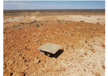
図3 「はやぶさ2」カプセル帰還時に設置した小型のインフラサウンドセンサー等（INF04）
