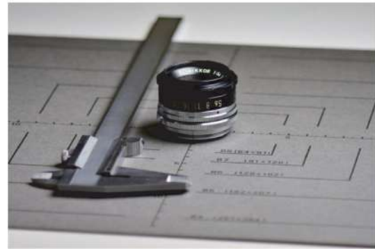
図 7 撮像面とレンズ面が平行の場合 絞り F8 シャッタースピード 1/125 s
