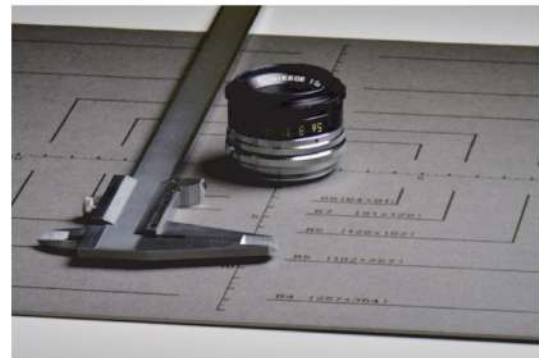
図 8 撮像面とレンズ面のボードを前面にティルトした場合 絞り F8 シャッタースピード 1/30 s
