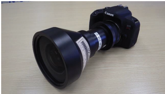
写真1 実験に用いたテレセントリックレンズとカメラ。
