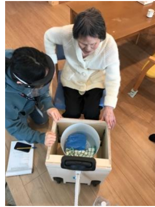
図6 足踏み洗濯機で実験中の様子
