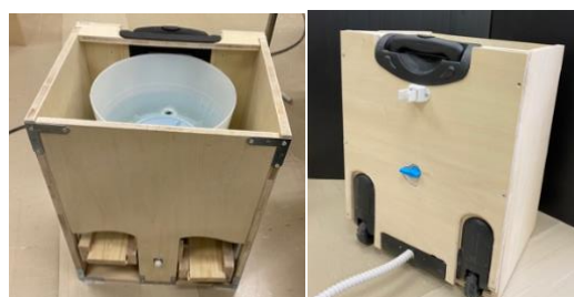
図5 実装した足踏み洗濯機のプロトタイプ
